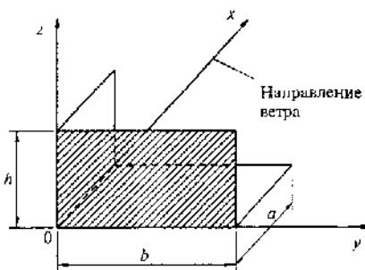
Рисунок 11.2 – Основная система координат при определении коэффициента корреляции  $\rho$
