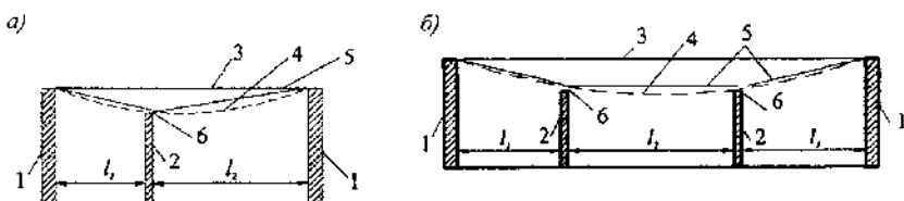
*а – одной в пролете; б – двух в пролете; 1 – несущие стены (или колонны); 2 – капитальные перегородки; 3 – покрытие (перекрытие) до приложения нагрузки; 4 – покрытие (перекрытие) после приложения нагрузки; 5 – линия отсчета прогиба; 6 – зазор*
