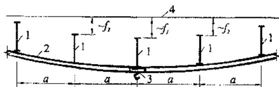
1 – стропильные конструкции; 2 – балка подвешенного кранового пути; 3 – подвешенный кран; 4 – исходное положение стропильных конструкций;  $f_1$  – прогиб наиболее нагруженной стропильной конструкции;  $f_2$  – прогибы смежных с наиболее нагруженной стропильных конструкций
